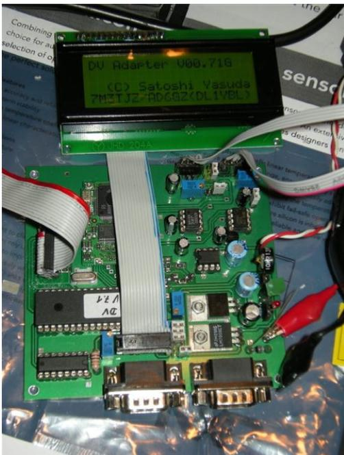
Der DV-Adapter, wie er als Bausatz beim Funkamateurladen angeboten wurde (neue Version wird in Kürze angeboten werden) Der DV-Adapter ermöglicht DSTAR Betrieb mit vielen 9600Baud-fähigen Funkgeräten.
