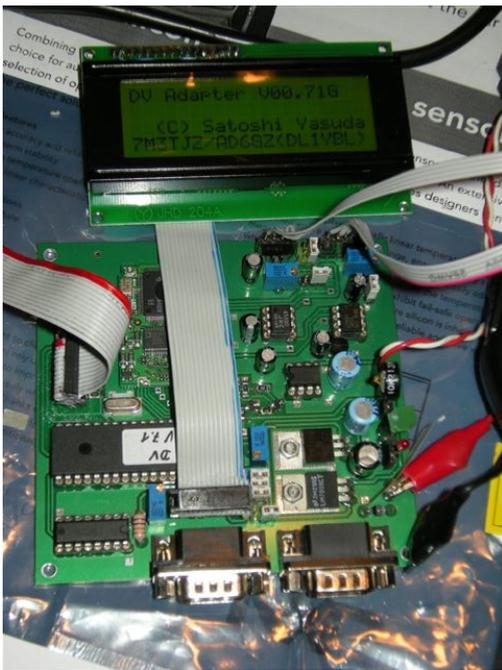
Der DV-Adapter, wie er als Bausatz beim Funkamateur angeboten wurde (neue Version wird in Kürze angeboten werden).
