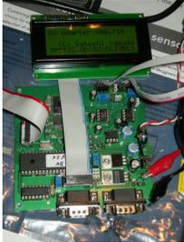
Der DV-Adapter, wie er als Bausatz beim Funkamateurland angeboten wurde (neue Version wird in Kürze angeboten werden) Der DV-Adapter ermöglicht DSTAR Betrieb mit vielen 9600Baud-fähigen Funkgeräten.
