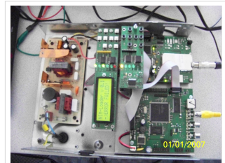
70cm ATV-Empfänger - Feldversuch im April 2010
