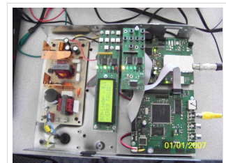
70cm ATV-Empfänger - Feldversuch im April 2010
