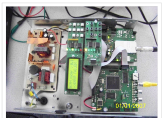
70cm ATV-Empfänger - Feldversuch im April 2010
