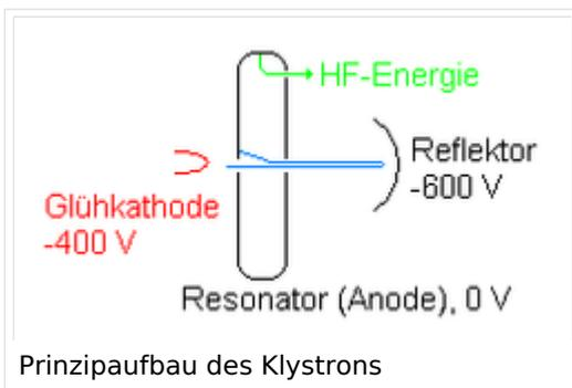
**Reflexklystron 1.jpg** Aus den Anfängen und der Frühzeit der Amateurfunk Mikrowellentechnik finden wir heute nur mehr wenige Applikationen und Berichte aus dem Angloamerikanischen Raum. Als Frequenzbestimmendes Element diente ein auf der passenden Frequenz abgestimmter Hohlraumresonator. Bevorzugt verwendet wurde das Reflexklystron vom Typ 723A/B, das ursprünglich für den Frequenzbereich von 9,5GHz entwickelt und von den Funkamateuren für den Betrieb im 3cm
