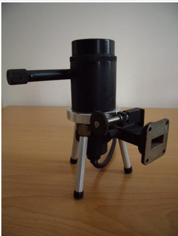
9GHz Klystron mit WR90 HL-Ausgang
