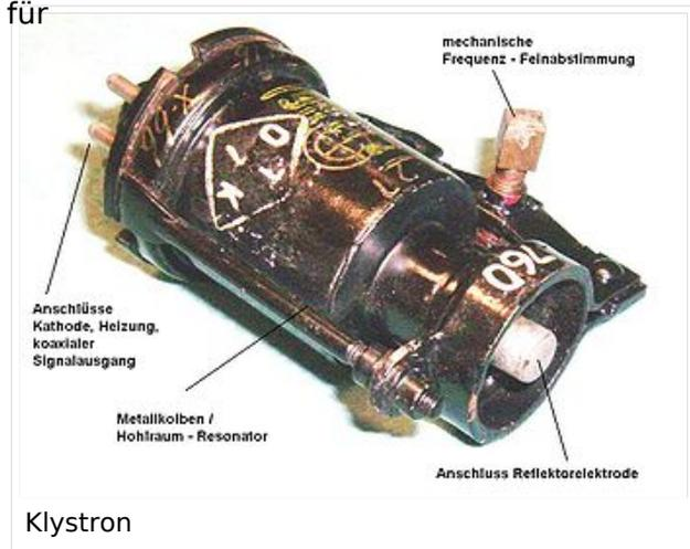
Das Klystron wurde 1937 an der Stanford University in Kalifornien von den Brüdern Varian und W. Webster entwickelt. Das Reflexklystron ist eine Laufzeitröhre,
