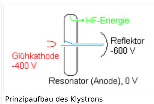
Aus den Anfängen und der Frühzeit der Amateurfunk Mikrowellentechnik finden wir heute nur mehr wenige Applikationen und Berichte aus dem Angloamerikanischen Raum. Als Frequenzbestimmendes Element diente ein auf der passenden Frequenz abgestimmter Hohlraumresonator. Bevorzugt verwendet wurde das
