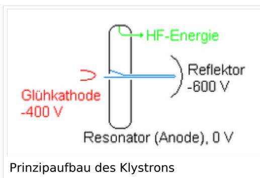
Aus den Anfängen und der Frühzeit der Amateurfunk Mikrowellentechnik finden wir heute nur mehr wenige Applikationen und Berichte aus dem Angloamerikanischen Raum. Als Frequenzbestimmendes Element diente ein auf der passenden Frequenz abgestimmter Hohlraumresonator. Bevorzugt verwendet wurde das Reflexklystron vom Typ 723A/B, das ursprünglich für den Frequenzbereich von 9,5GHz entwickelt und von den Funkamateuren für den Betrieb im 3cm
