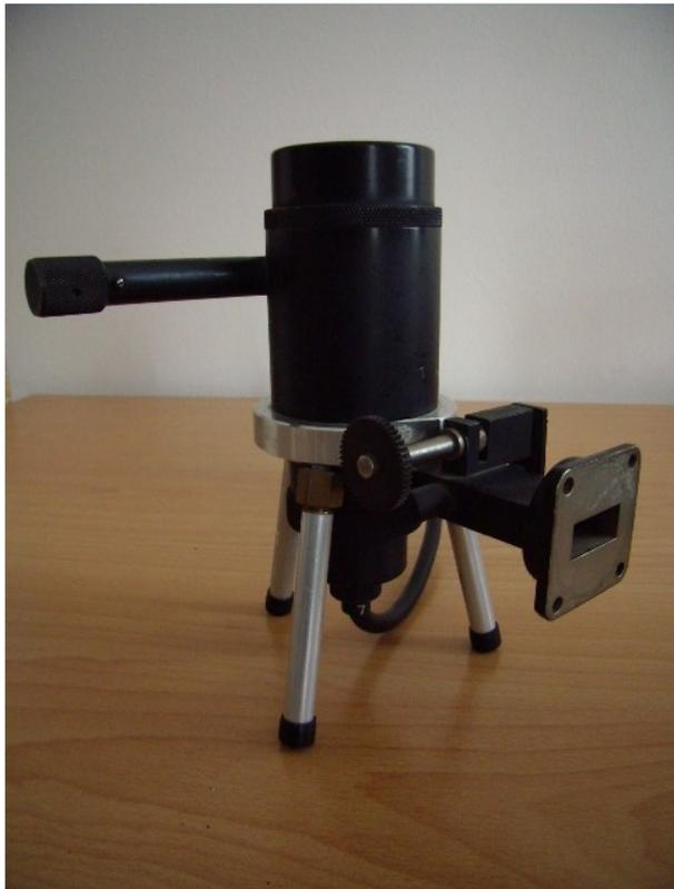
9GHz Klystron mit WR90 HL-Ausgang
