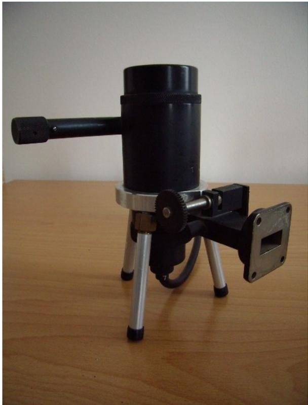
9GHz Klystron mit WR90 HL-Ausgang
