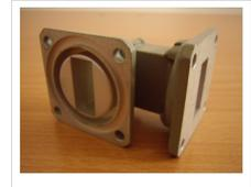
Elliptische Hohlleiter zu erwähnen welche durch ihre gewellte Oberflächenstruktur eine einmalige Verformung des Hohlleiters während der Verlegung zulassen. Der Vergleich mit der Verlegung von Wasserleitungsrohren ist dabei nicht ganz von der Hand zu weisen und führte daher zum Begriff "plumbers band". Im Bild, WR90 Hohlleiter Bögen 90°, für H und E-Ebene für den Frequenzbereich von 8 bis 12GHz.
