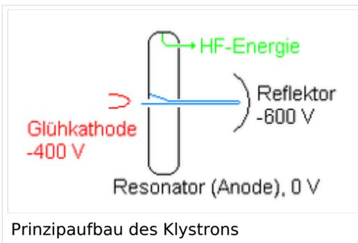
Aus den Anfängen und der Frühzeit der Amateurfunk Mikrowellentechnik finden wir heute nur mehr wenige Applikationen und Berichte aus dem Angloamerikanischen Raum. Als Frequenzbestimmendes Element diente ein auf der passenden Frequenz abgestimmter Hohlraumresonator. Bevorzugt verwendet wurde das Reflexklystron vom Typ 723A/B, dass ursprünglich für
