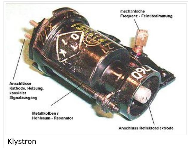
Hohlraumresonator. Bevorzugt verwendet wurde das Reflexklystron vom Typ 723A/B, das ursprünglich für den Frequenzbereich von 9,5 GHz entwickelt und von den Funkamateuren für den Betrieb im 3cm Amateurfunkband für einen Frequenzbereich von 10,0 bis 10,5GHz modifiziert wurde. Die erzielbare HF Ausgangsleistung lag im Bereich von bis zu 100mW.
