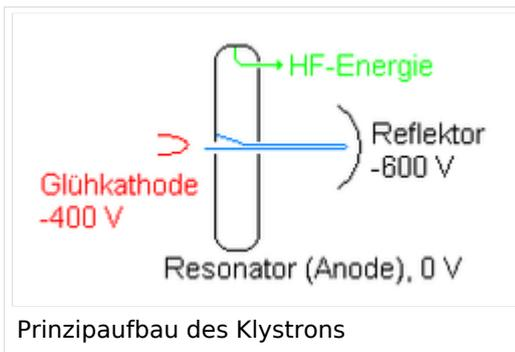
Aus den Anfängen und der Frühzeit der Amateurfunk Mikrowellentechnik finden wir heute nur mehr wenige Applikationen und Berichte aus dem Angloamerikanischen Raum. Als Frequenzbestimmendes Element diente ein auf der passenden Frequenz abgestimmter Hohlraumresonator. Bevorzugt verwendet wurde das Reflexklystron vom Typ 723A/B, dass ursprünglich für den Frequenzbereich von 9,5GHz entwickelt und von den Funkamateuren für den Betrieb im 3cm
