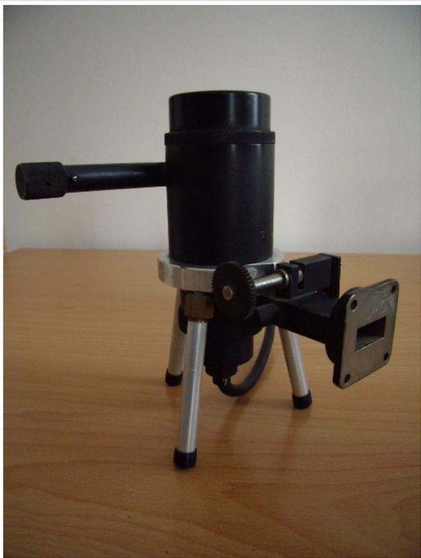
9GHz Klystron mit WR90 HL-Ausgang
