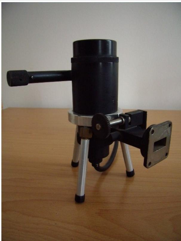
9GHz Klystron mit WR90 HL-Ausgang
