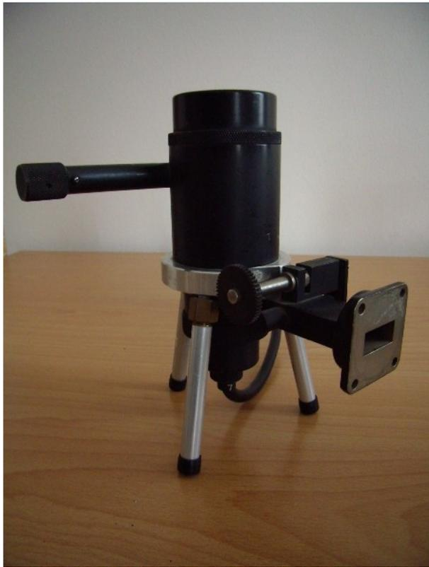
9GHz Klystron mit WR90 HL-Ausgang
