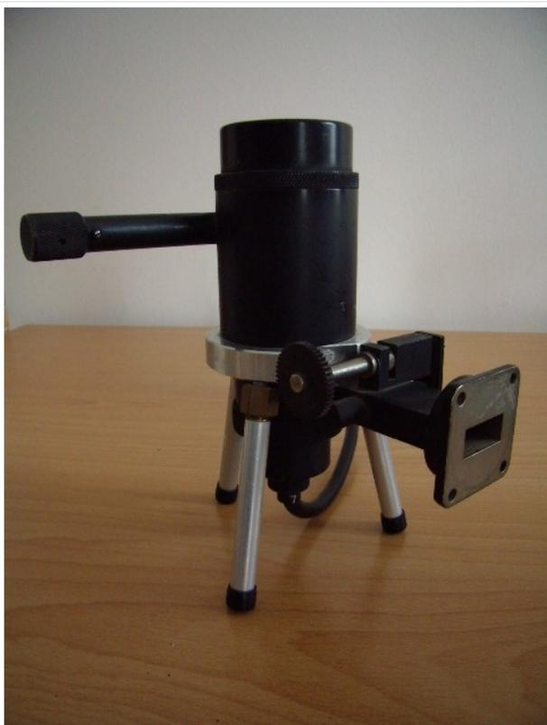
9GHz Klystron mit WR90 HL-Ausgang
