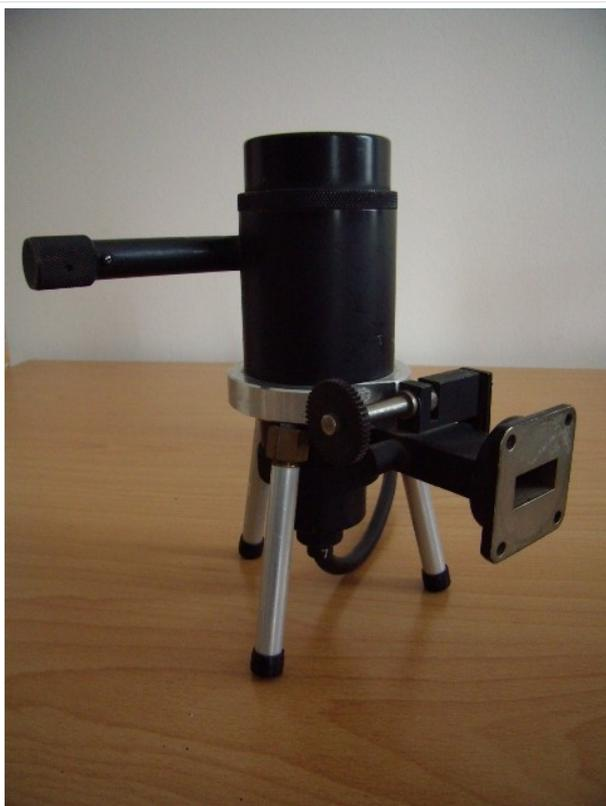
9GHz Klystron mit WR90 HL-Ausgang
