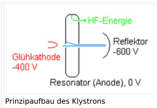
Prinzipaufbau des Klystrons
