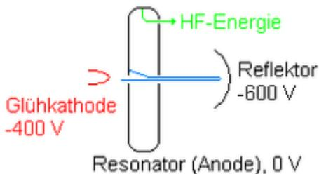
Prinzipaufbau des Klystrons
