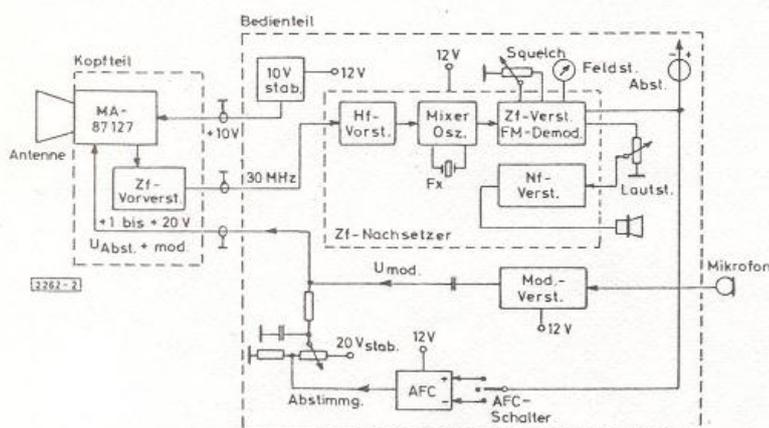
Abb. 2. 10-GHz-Transceiver, Blockschaltbild
