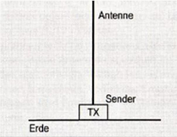
Das Diagramm zeigt eine vertikale Linie, die als 'Antenne' beschriftet ist, die von einem rechteckigen Block auf der Erde, beschriftet mit 'TX' und 'Sender', nach oben verläuft. Die Erde ist durch eine horizontale Linie am unteren Rand des Diagramms dargestellt. |
