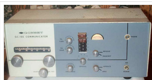
Der Gonset GC-105 "Gooney Bird" Communicator ist ein AM Transceiver für 12 /110V Betrieb
