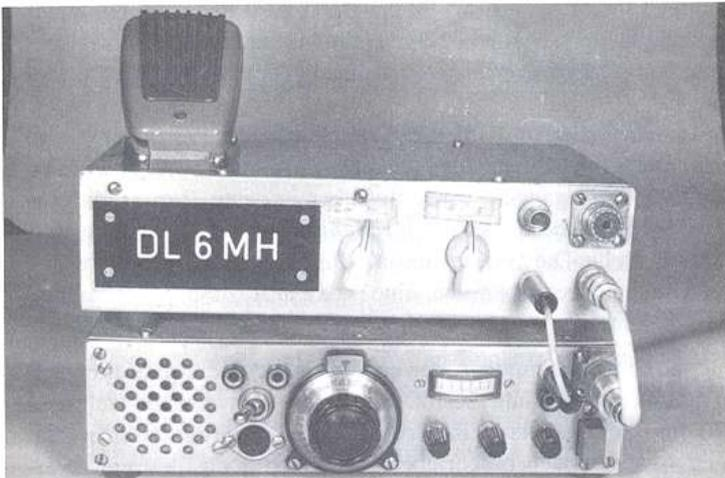
Bild 3. Geräte-Satz für das 70-cm-Band. Der Unterteil ist ein 2-m-Transceiver, darüber der 70-cm-Zusatz.
