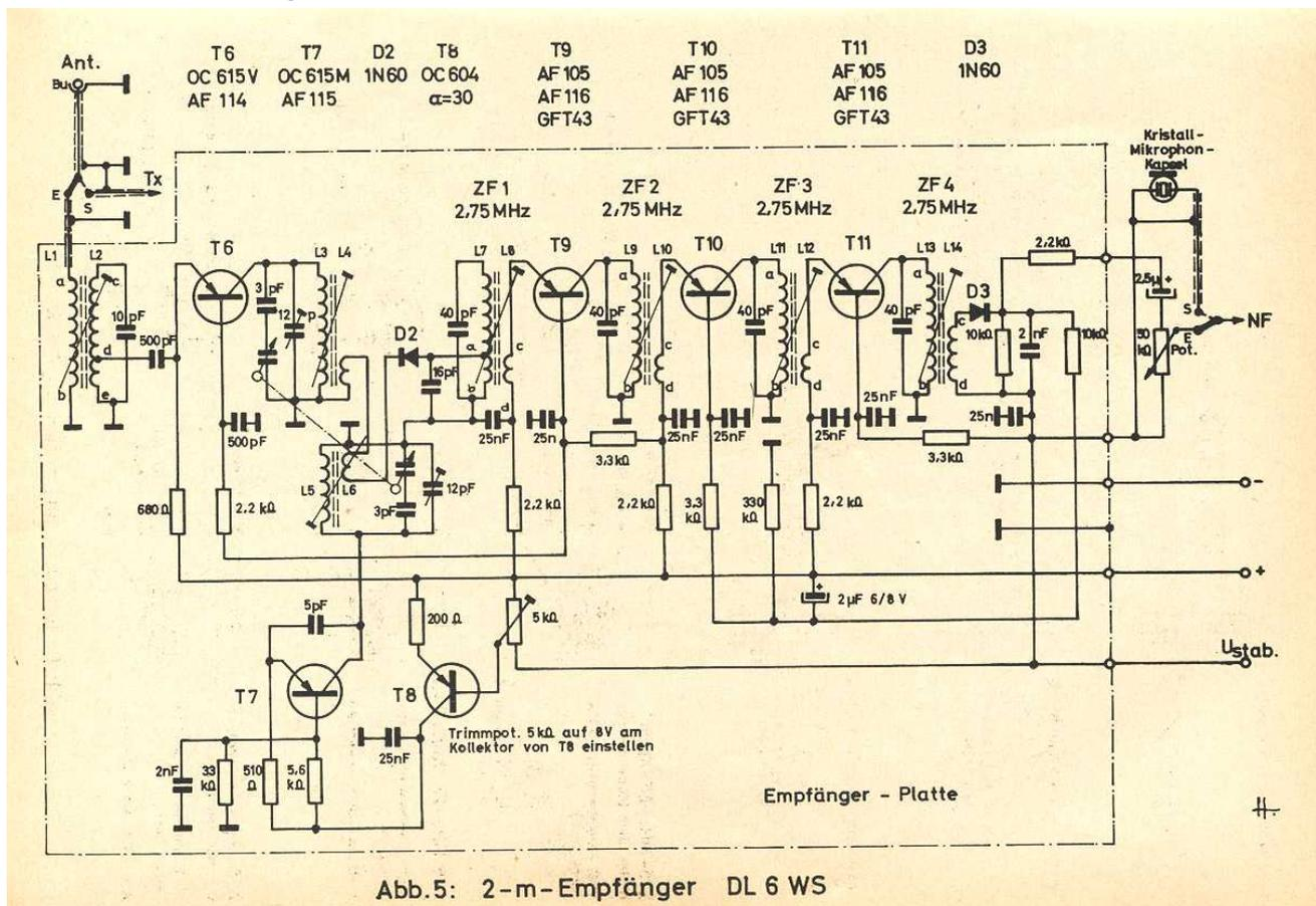
Abb.5: 2-m-Empfänger DL 6 WS
