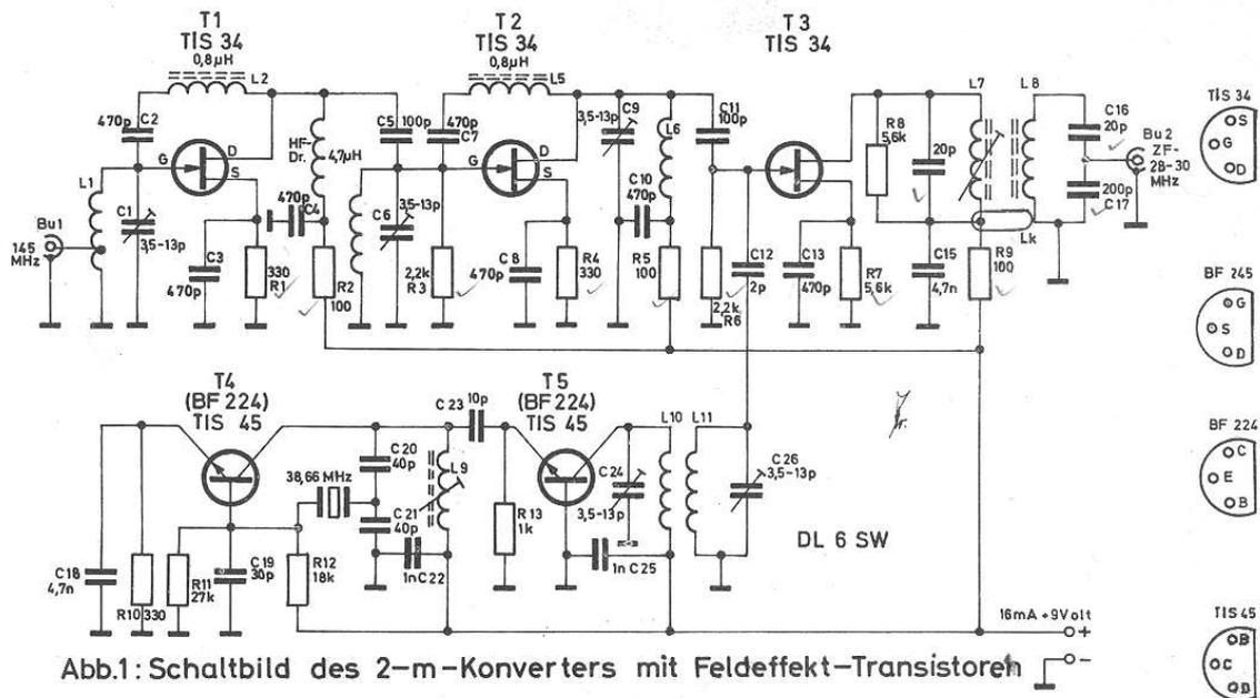
Abb.1: Schaltbild des 2-m-Konverters mit Feldeffekt-Transistoren
