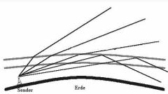
Das Diagramm zeigt die Ausbreitung von Kurzwellen. Ein Sender (links) sendet Wellen aus, die über die gekrümmte Oberfläche der Erde (rechts) reflektiert werden. Die Wellenfronten sind als Linien dargestellt, die von der Erde abprallen und zurück zum Sender reflektiert werden.<br><small>Sender Erde</small> | 511 ×<br>281 (24 KB) | <a href="#">Anonym</a> ( <a href="#">Diskussion</a>   <a href="#">Beiträge</a> ) | Kurzwellenausbreitung |
