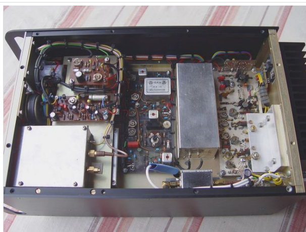
Neukonstruktion des SSB/FM-2m-Transceivers aus SEMCO-Bausteinen
