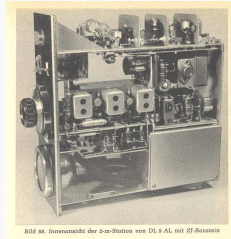
2m Station von DL9AL mit Zf-Baustein
