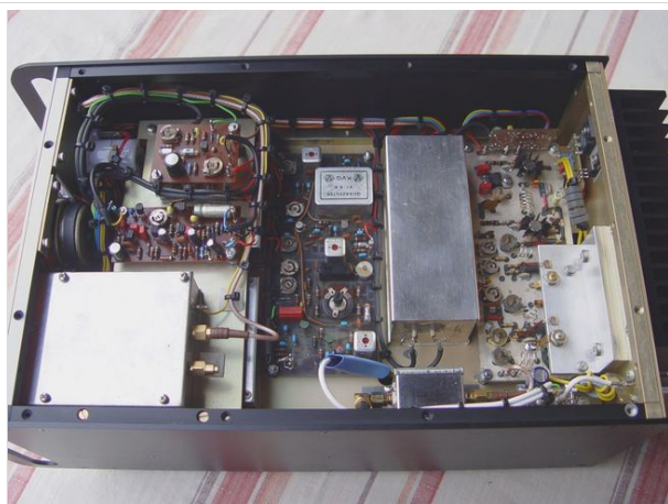
Neukonstruktion des SSB/FM-2m-Transceivers aus SEMCO-Bausteinen
