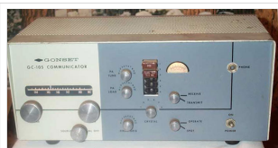
Der Gonset GC-105 "Gooney Bird" Communicator ist ein AM Transceiver für 12 /110V Betrieb
