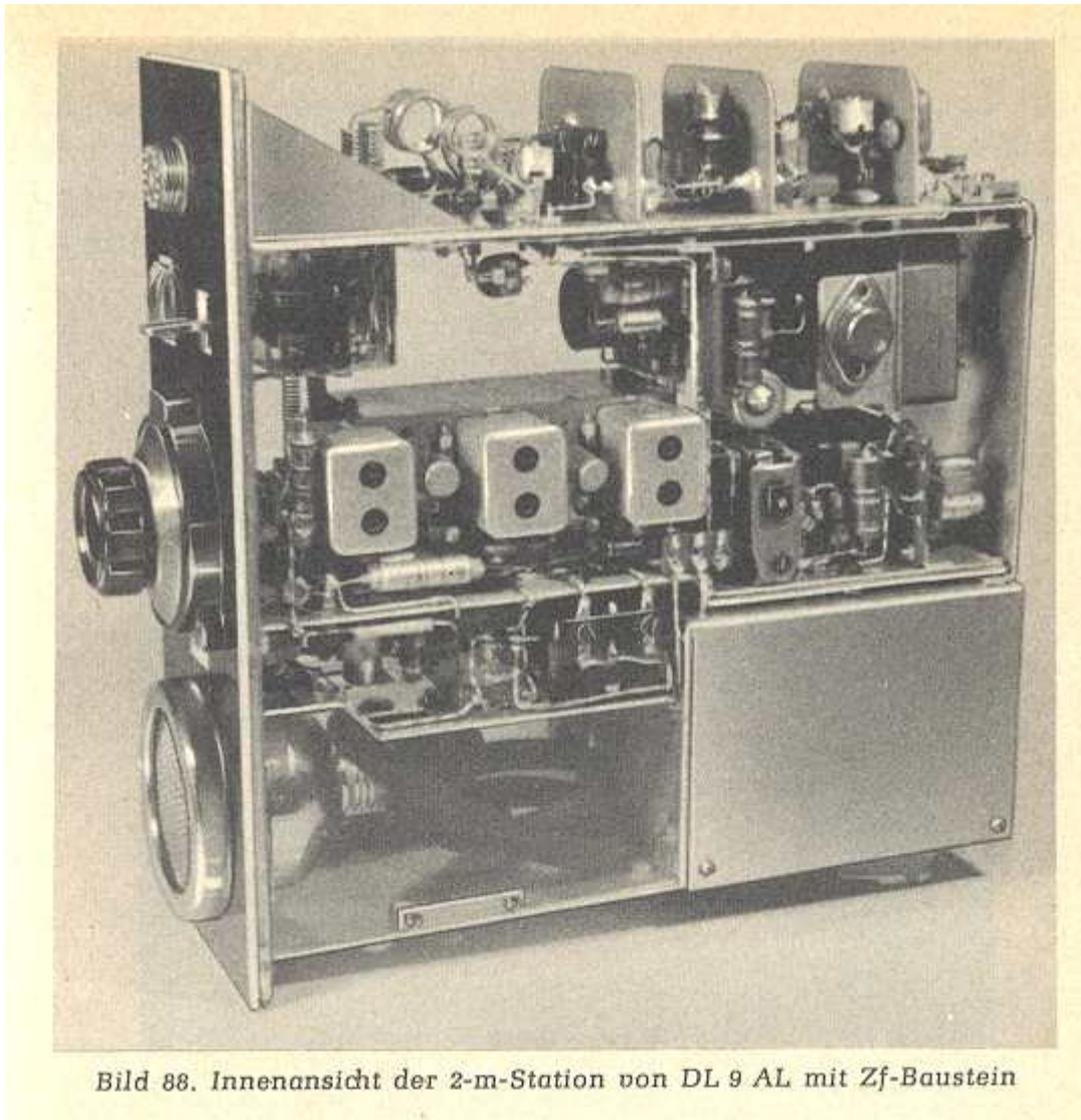
Bild 88. Innenansicht der 2-m-Station von DL 9 AL mit Zf-Baustein
