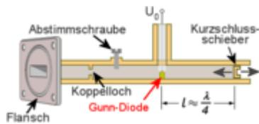
Der Aufbau des GUNN Elements besteht aus hintereinander geschalteten unterschiedlich dotierten Materialien, wie Galliumnitrid bzw. Indiumphosphid. Diese Materialien stellen eine Elektronenfalle dar, es entsteht eine Art negativer Widerstand, die Elektronen werden gestaut und wandern in Schüben durch das Element. Mit
