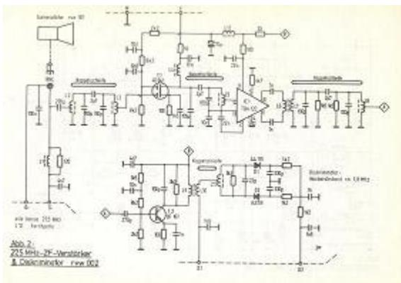
Die vom Diskriminator abgegriffene DC Spannung wurde zur Erzeugung einer AFC (Automatic Frequency Control) Spannung verwendet um die Frequenzdrift der eigenen bzw. der Gegenstation ausgleichen zu können. Dabei genügte, dass nur eine Funkstation die AFC eingeschaltet hatte. Das de-modulierte Audiosignal wurde in einer NF Stufe verstärkt, die Wiedergabe erfolgte über Kopfhörer damit keine Audiorückkopplung über das Mikrofon (wegen des Duplexbetriebes war man ja immer auf Sendung) auftreten konnte.
