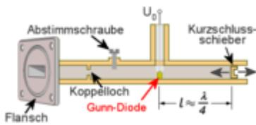
Der Aufbau des GUNN Elements besteht aus hintereinander geschalteten unterschiedlich dotierten Materialien, wie Galliumnitrid bzw. Indiumphosphid. Diese Materialien stellen eine Elektronenfalle dar, es entsteht eine Art negativer Widerstand, die Elektronen werden gestaut und wandern in Schüben durch das Element.
