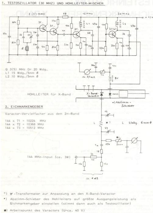
Eine weiteres Hilfsmittel war die 30MHz Testloop Einrichtung, die auch in der kommerziellen Richtfunktechnik, jedoch für eine ZF von 70MHz verwendet wurde. Damit konnte man ohne Gegenstation das ausgesendetes HF Signal wieder rück-empfangen und damit vor allem die Modulationseigenschaften überprüfen.
