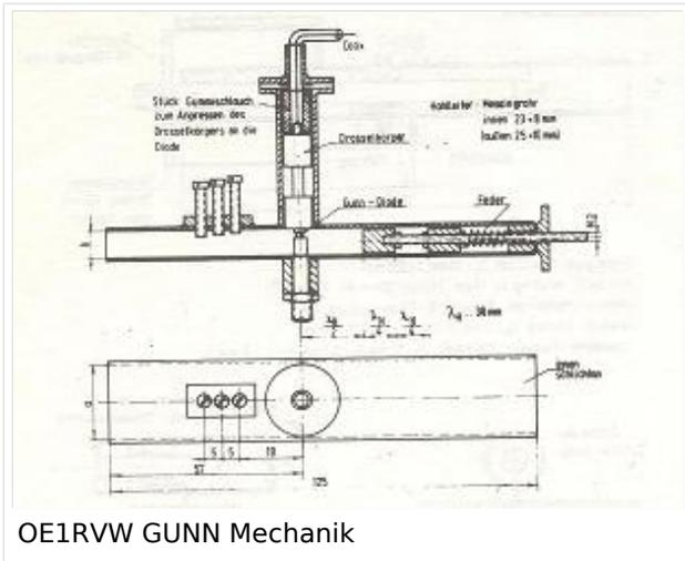
Die Versorgungsspannung des GUNN Elements wurde zur Erzeugung der Modulation mit der NF Spannung beaufschlagt was in der Praxis eine Mischung von FM und AM Modulation ergab. Gleichzeitig konnte mit geringer Änderung der GUNN Versorgungsspannung eine gewisse Feinabstimmung der Endfrequenz erreicht werden.
