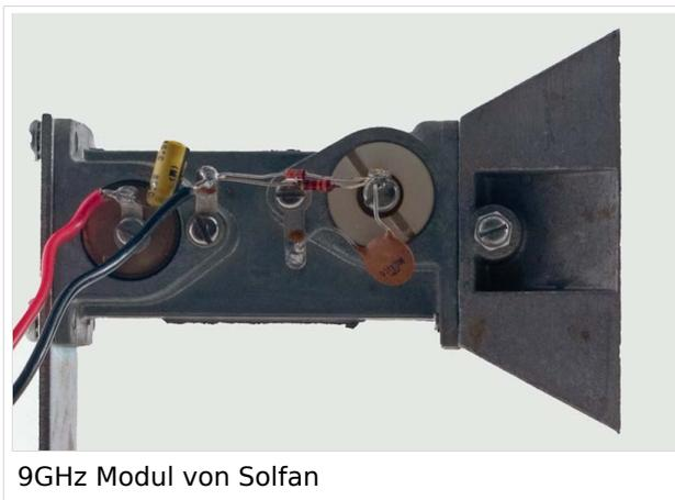
Nachdem die doch einigermaßen mühevollen mechanischen Anfertigungen eines GUNN Oszillators mit Varactor und Mischdiode durch die Verfügbarkeit von fertigen GUNN-Plexer Modulen entfiel, stieg die Akzeptanz und das Interesse für das 3cm Band in Amateurkreisen schlagartig an. In den späten 70er und Anfang der 80er wurden viele Baubeschreibungen in DL, UK und USA veröffentlicht wobei sich das Hauptaugenmerk auf die ZF Schaltung, dem Modulator, der AFC und der Antenne richtete.
