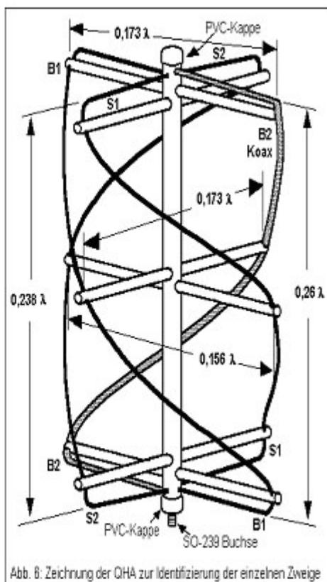
Um die Konfusion betreffend die Verbindungen und die Identifizierung der einzelnen Windungen zu minimieren wird jede Helix mit B (=big) und S (=small) bezeichnet; entsprechend dem großen und dem kleinen Zylinder. T (=top) und B (=bottom) bezeichnen den Ober- bzw. den Unterteil der Antenne. Auf den Abbildungen ist das Bezeichnungssystem gut zu erkennen. Jede
