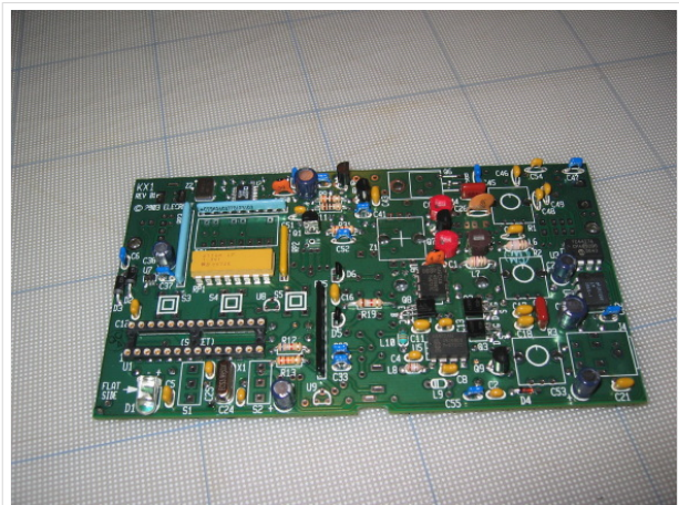
Hauptplatine mit alle niedrigen Teilen
