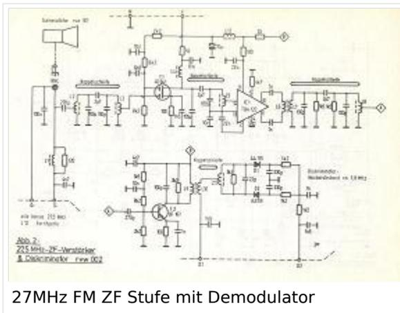
27MHz FM ZF Stufe mit Demodulator
