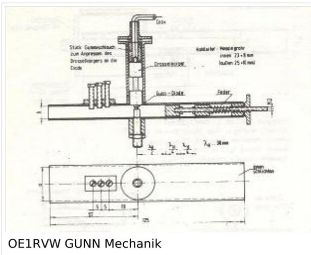
Der TX/RX Teil dieser von OE1RVW gebaute ersten Transverter-Generation aus dem Jahre 1976 bestand nur aus dem GUNN Element selbst, das gleichzeitig zur Erzeugung der Ausgangsfrequenz, als Sender und als Empfangsmischer verwendet und in einem Hohlleiter Resonator eingebaut wurde.
