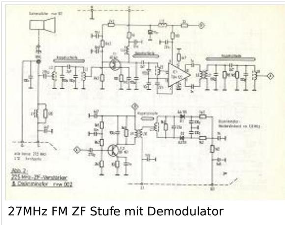
27MHz FM ZF Stufe mit Demodulator
