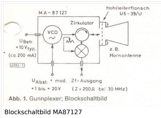
Das Modul wurde anschlussfertig und mit einem 17db Rechteckhorn geliefert, damit entfielen die Mechanischen und Messtechnischen Anforderungen und man konnte ohne spezielle Kenntnisse der Mikrowellentechnik auf dem 3cm Band QRW werden.
