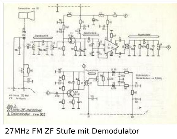
27MHz FM ZF Stufe mit Demodulator
