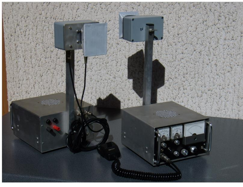
Das Bild links zeigt einen 3cm WBFM MA87127 Gunnplexer von OE3WOG, anstelle des Instruments wurde am 10 Gang Potentiometer ein 3stelliges mechanisches Zählwerk
