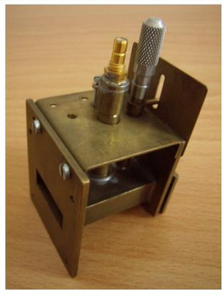
Die mechanische (grobe) Frequenzabstimmung erfolgte über einen Plexiglasstab der über ein Spindel angetrieben in den Hohlleiterresonator eintauchte. Diese Gunn-Plexer Version war noch nicht für eine separate Varaktordiode ausgelegt und war nur mit dem Gunn Element und einer Mischdiode ausgerüstet. Die Feinabstimmung der Arbeitsfrequenz wurde durch geringfügige Veränderungen der GUNN Versorgungsspannung durchgeführt.
