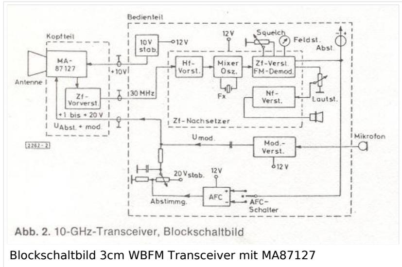
Abb. 2. 10-GHz-Transceiver, Blockschaltbild
