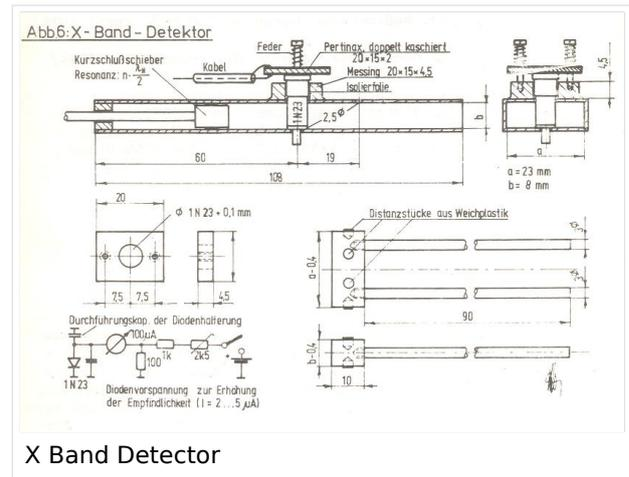
Diese Methode war natürlich nicht sehr präzise aber man konnte in der Praxis eine Frequenzablesegenauigkeit von ca. +/-50MHz, abhängig von der mechanischen Präzision der Kurzschlußschieberspindel, erreichen. Immerhin wußte man ob man (noch) im zugewiesenen Frequenzband war.
