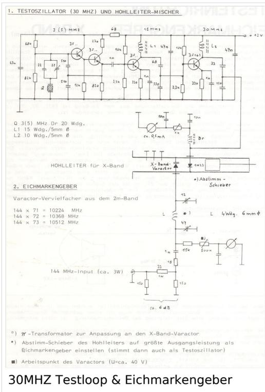
Mit der Installation einer Varaktordiode im Hohlleiter der Testloop Einrichtung konnte man die 72.te Oberwelle eines 2m Signal (144 MHz) auf 10.368 MHz erzeugen und hatte damit eine einigermaßen stabile HF Signalquelle (HF Generator) zur Überprüfung des eigen 3cm Empfangsteils zur Verfügung. Man sieht schon, auch damals waren wir nicht auf beiden Augen blind.
