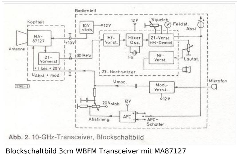
Abb. 2. 10-GHz-Transceiver, Blockschaltbild
