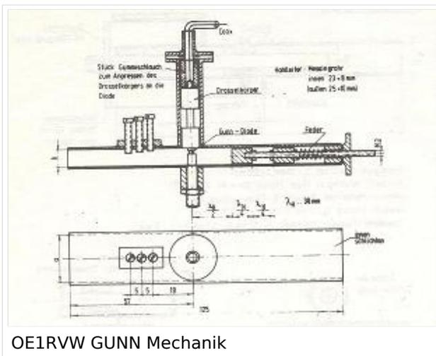
Der TX/RX Teil dieser von OE1RVW gebauten ersten Transverter-Generation aus dem Jahre 1975 bestand nur aus dem GUNN Element selbst, das gleichzeitig zur Erzeugung der Ausgangsfrequenz, als Sender und als Empfangsmischer verwendet und in einem Hohlleiter Resonator eingebaut wurde.
