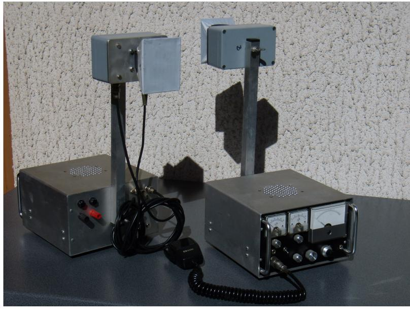
17db Rechteckhörner war die Einstellung der Antennnerichtung (Azimut & Elevation) nicht besonders kritisch und man konnte ohne Antennendreheinrichtungen im Portabel Betrieb auskommen.
