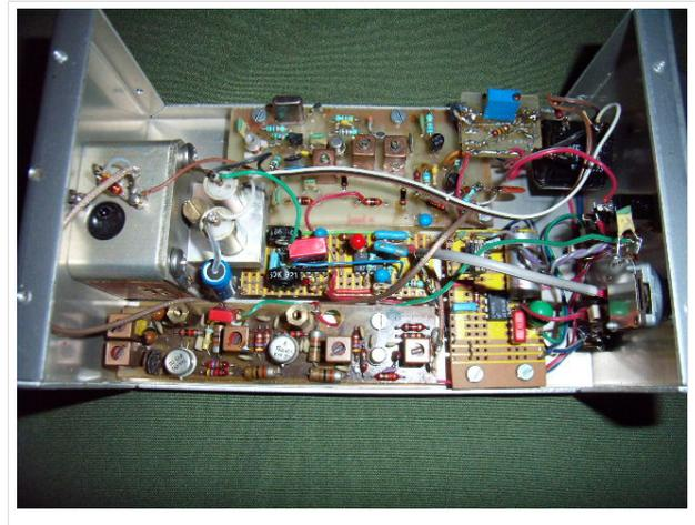
Zählwerk angeordnet um die Frequenz bestimmen zu können. Das Horn ist "homebrew" und sollte ca. 27db Gewinn aufweisen. Das Bild rechts zeigt den Innenaufbau des Gunn Transceiers mit dem MA87127 und der Umsetzung von 30 MHz ZF auf eine 10,7MHz ZF Stufe.
