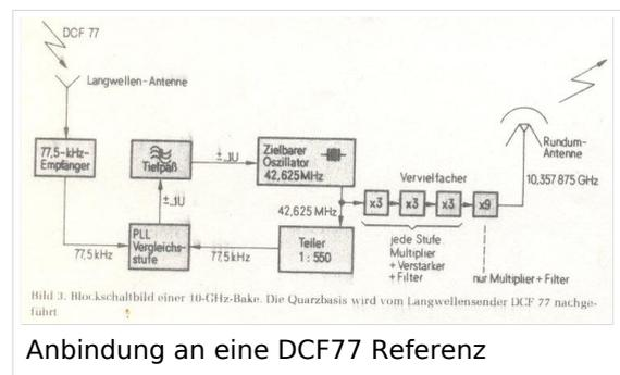
Bild 3. Blockschaltbild einer 10-GHz-Bake. Die Quarzbasis wird vom Langwellensender DCF 77 nachgeführt
