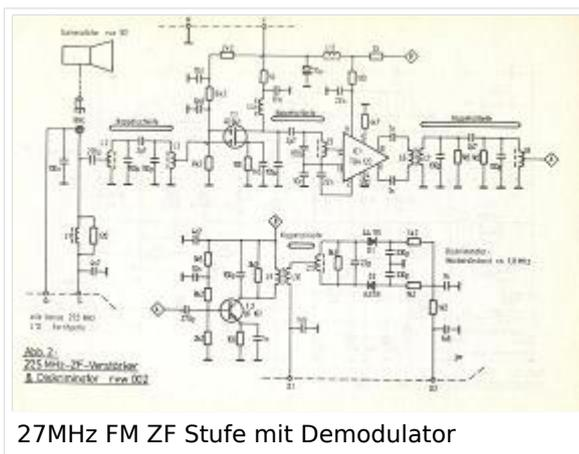
27MHz FM ZF Stufe mit Demodulator
