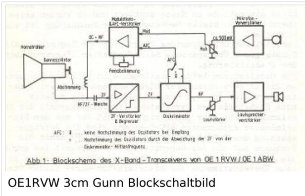
Richard baute in den 70er Jahren des 19ten Jahrhunderts die ersten 3cm GUNN Transceiver, mechanische Absorptionswellenmesser, 30 MHz Testloop Einrichtungen und Eichmarkengeber für die Optimierung Seiner selbstgebauten 3cm Geräte. OE1RVW und OE1ABW führten das Erst QSO auf dem 3cm Band in OE über eine Entfernung von 1,5km durch.
