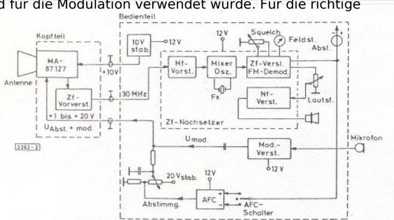
Abb. 2. 10-GHz-Transceiver, Blockschaltbild
