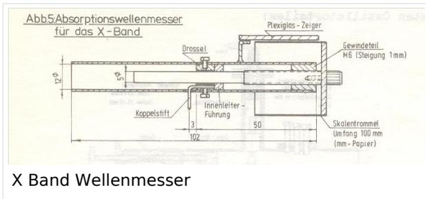
Um die Endfrequenz auf dem 3cm Band zu prüfen mußte man sich einen Wellenmesser selbst anfertigen. Frequenzzähler für den Frequenzbereich über 10GHz standen den Funkamateuren damals nicht zur Verfügung. Der Wellenmesser bestand üblicherweise aus 2 Teilen: a) dem Absorptionskreis (Bild links) und b) dem X Band Detektor (Bild rechts). Der
