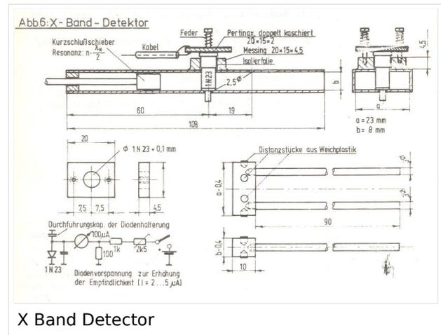
Detektor koppelte über eine Sonde in den Hohlraumresonator des Wellenmessers ein. Wurde ein 10GHz Signal in den Absorptionskreis eingespeist, so konnte mit der Kurzschlußschieberspindel auf maxima und minima Pegelanzeige abgestimmt werden. Am Wellenmesser war eine in kalibrierte Trommelskala befestigt an der man die Zwischenabstände der Dips in mm ablesen konnte. Das Längenergebnis wurde dann auf die Frequenz umgerechnet.
