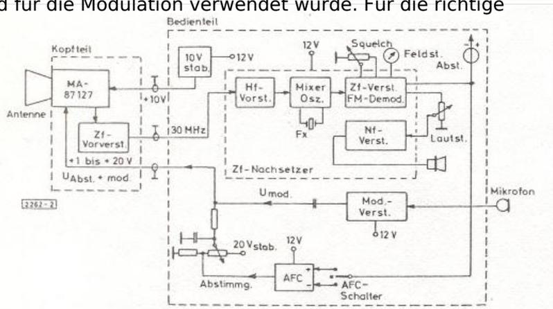
Abb. 2. 10-GHz-Transceiver, Blockschaltbild
