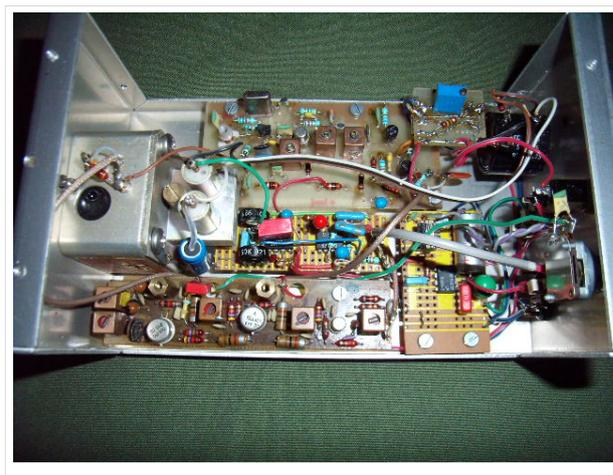
3stellige mechanisches Zählwerk angeordnet um die Frequenz bestimmen zu können. Das Horn ist "homebrew" und sollte ca. 27db Gewinn aufweisen. Das Bild rechts zeigt den Innenaufbau des Gunn Transceiers mit dem MA87127 und der Umsetzung von 30 MHz ZF auf eine 10,7MHz ZF Stufe.
