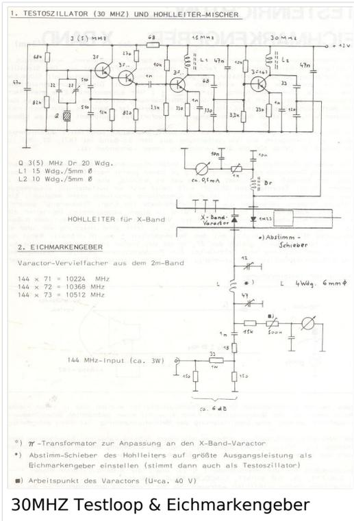
Dazu wurde ein 30MHz HF Signal auf eine im Hohlleiter montierte Mischdiode gelegt. Wurde ein 3cm HF Signal von einem GUNN Oszillator in den Hohlleiter eingekoppelt dann mischte die Diode das Eingangssignal mit dem 30MHz Signal und es entstanden als Mischprodukte im 3cm Band zwei Seitenbänder im Abstand von je 30MHz. Damit konnte das eigene ausgesendete Signal wieder rückempfangen und beurteilt werden, sofern die eigene ZF bei 30MHz lag.
