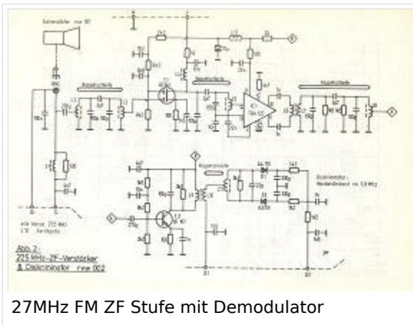
27MHz FM ZF Stufe mit Demodulator
