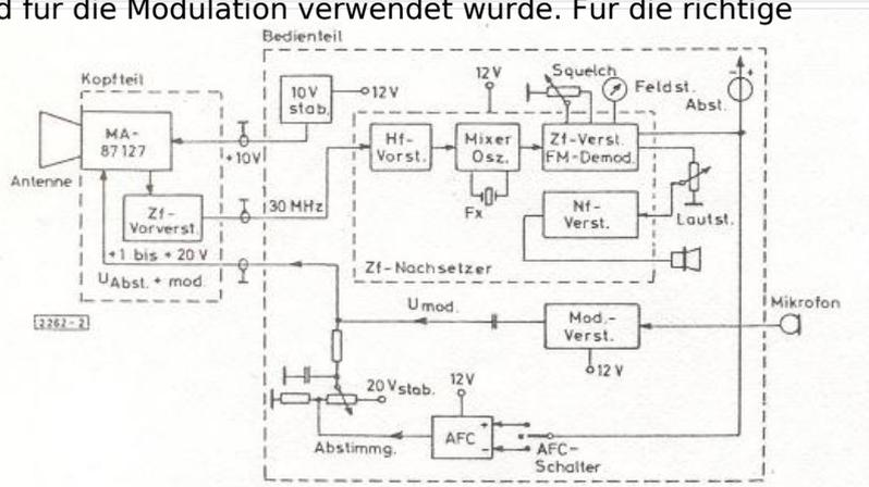
Abb. 2. 10-GHz-Transceiver, Blockschaltbild
