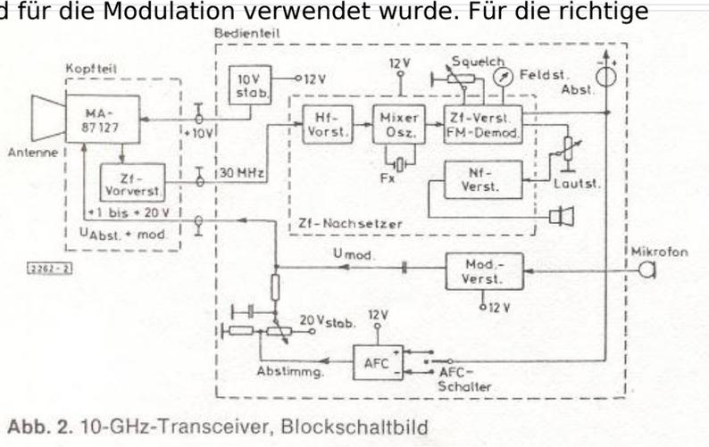
Abb. 2. 10-GHz-Transceiver, Blockschaltbild
