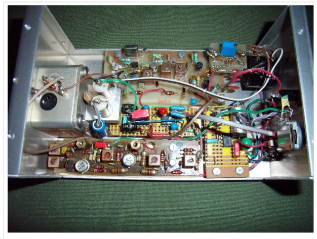
3stellige mechanisches Zählwerk angeordnet um die Frequenz bestimmen zu können. Das Horn ist "homebrew" und sollte ca. 27db Gewinn aufweisen. Das Bild rechts zeigt den Innenaufbau des Gunn Transceiers mit dem MA87127 und der Umsetzung von 30 MHz ZF auf eine 10,7MHz ZF Stufe.
