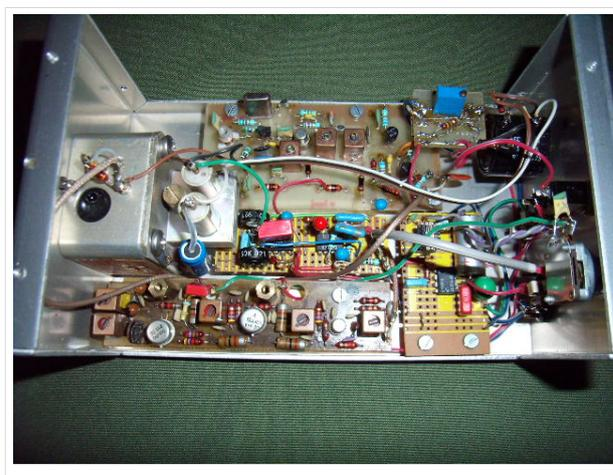
3stellige mechanisches Zählwerk angeordnet um die Frequenz bestimmen zu können. Das Horn ist "homebrew" und sollte ca. 27db Gewinn aufweisen. Das Bild rechts zeigt den Innenaufbau des Gunn Transceivers mit dem MA87127 und der Umsetzung von 30 MHz ZF auf eine 10,7MHz ZF Stufe.
