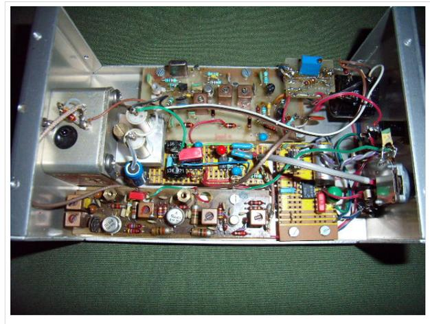
3stellige mechanisches Zählwerk angeordnet um die Frequenz bestimmen zu können. Das Horn ist "homebrew" und sollte ca. 27db Gewinn aufweisen. Das Bild rechts zeigt den Innenaufbau des Gunn Transceivers mit dem MA87127 und der Umsetzung von 30 MHz ZF auf eine 10,7MHz ZF Stufe.
