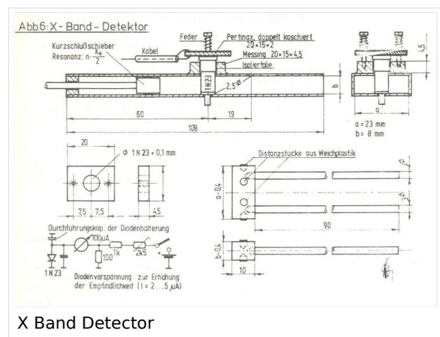
Diese Methode war natürlich nicht sehr präzise aber man konnte in der Praxis eine Frequenzablesegenauigkeit von ca. +/-50MHz, abhängig von der mechanischen Präzision der Kurzschlußschieberspindel, erreichen. Immerhin wußte man ob man (noch) im zugewiesenen Frequenzband war.
