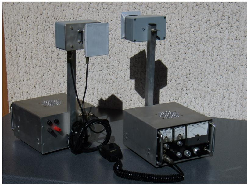
Das Bild links zeigt Front und Rückseite der beiden 3cm Gunnplexer von OE3WRA. Die Antennen sind mit Kunststoffolie gegen Wind und Feuchtigkeit geschützt. Die Antenne ist direkt mit dem MA87127 Gunnplexer verschraubt. Hier wurden bereits Normflansche passend für WR90 vorgesehen was diverse Messungen mit kommerziellen Meßgeräten wesentlich erleichterte. Die Steuerung des Transceivers, ZF Stufe und Modulator befinden sich im unten angebrachten
