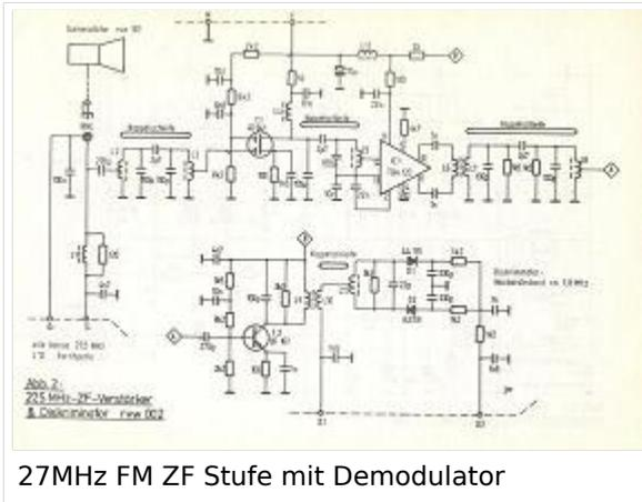
27MHz FM ZF Stufe mit Demodulator
