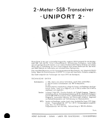
Tragbares UKW Funkgerät für SSB/AM /CW (1966)
