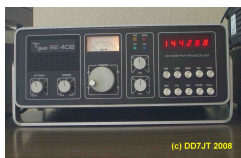
Tischgerät SE 402, FM, SSB, CW; Pout: 10 W (1977)
