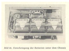
Unterbringung der Batterien unter dem Chassis DJ5MM
