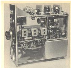
Bild 43. Innenansicht der 2m-Station von DL9AL mit Zf-Baustein
