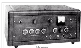
Clegg Climaster 62T10 Transmitter für das 11 /10/6/2 Meter Band
