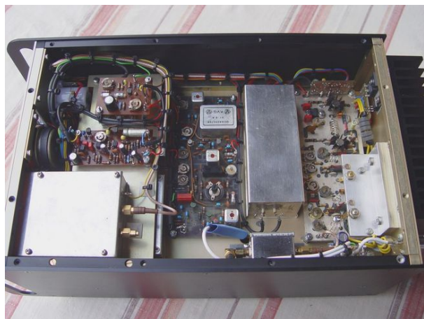
Neukonstruktion des SSB/FM-2m- Transceivers aus SEMCO-Bausteinen
