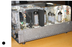
Detailansicht der Endstufe
