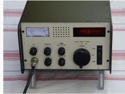
Neukonstruktion DK4SX, mit Umschalter FM/SSB und Relaisablage
