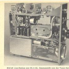
Bild 47. 2-m-Station von DL 9 AL, Innensicht von der Tuner-Seite
