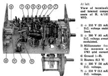
Dieser Steuer sender wurde entwickelt, um zwei speziellen Anforderungen zu entsprechen: Stabiler Quarzoszillator und ein VFO
