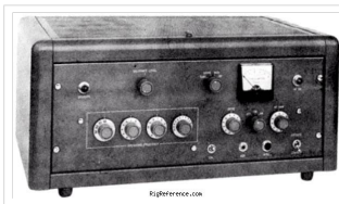
Clegg Climaster 62T10 Transmitter für das 11 /10/6/2 Meter Band
