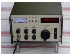
Neukonstruktion DK4SX, mit Umschalter FM/SSB und Relaisablage
