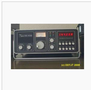
Tischgerät SE 402, FM, SSB, CW; Pout: 10 W (1977)
