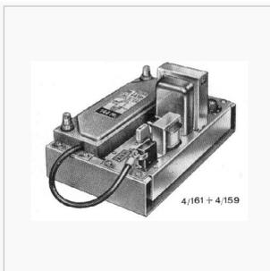
1963 wurden mehrere VHF Nuvistor-Konverter entwickelt, hier die 2m Ausführung G.4 /161 zusammen mit der Stromversorgung G.4/159
