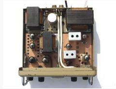
Quarzgesteuerter CW /AM Sender für das 2m Amateurband.
